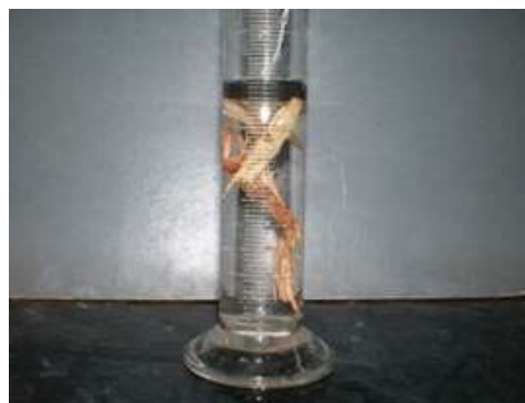
写真－9.9 水に浮く不純物の測定状況
