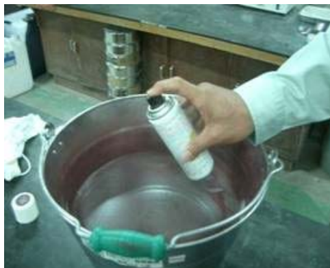
写真－10.18 計量目盛付バケツ作成
