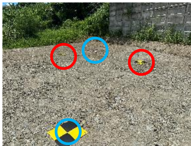
標定点及び検証点設置
