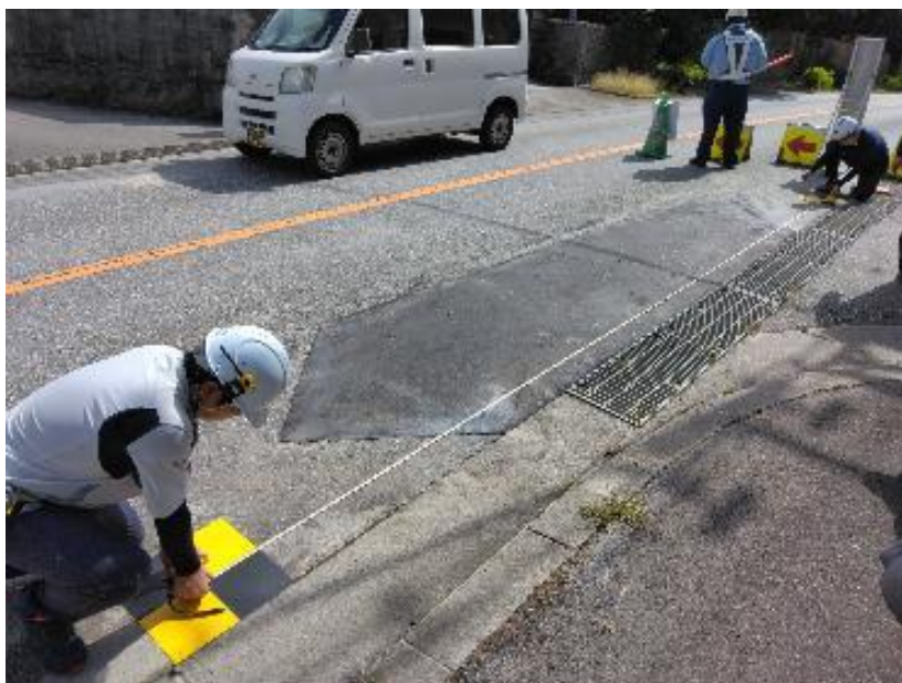
標定点2点間距離計測状況(巻尺使用)
