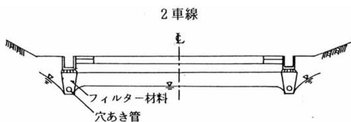
図 5-15 両側の路側に設けられた地下排水溝
