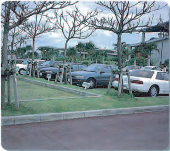
② 駐車場にブロック舗装を用い、芝生や樹木を植栽し、また、一般舗装面は透水性舗装を使用し、涼しさを演出している。 (宜野湾海浜公園施設、宜野湾市)
