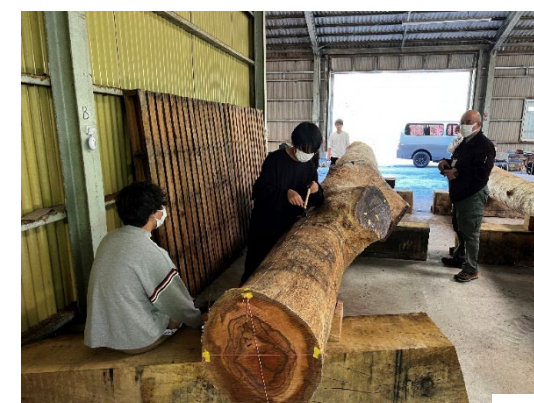
非破壊強度試験状況
