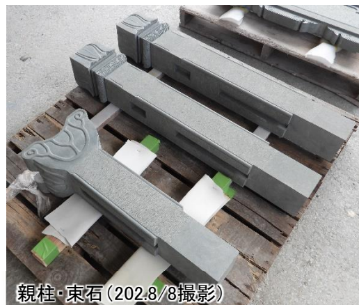
親柱、束石、笠石、地覆石などの荒彫り状況(2024.6/5撮影)
