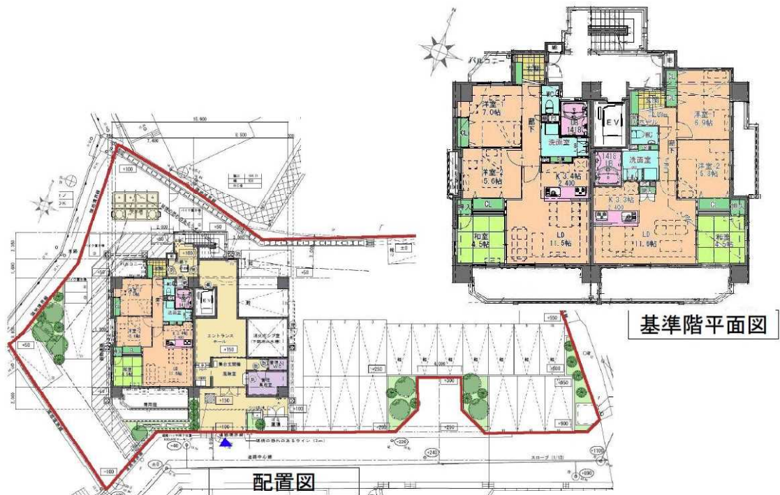
図 5-2 丸竹ファミリーマンション（建替え後）の配置図・基準階平面図
