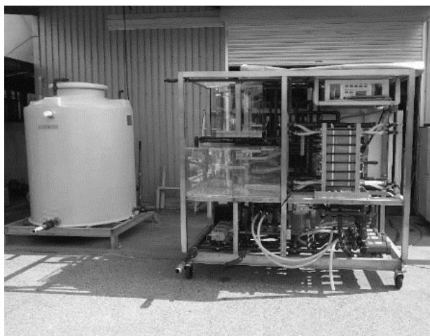
図9 イオン交換膜法による海水濃縮装置
