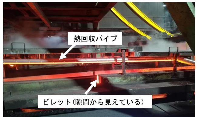
図4 工場に設置した熱回収パイプ
