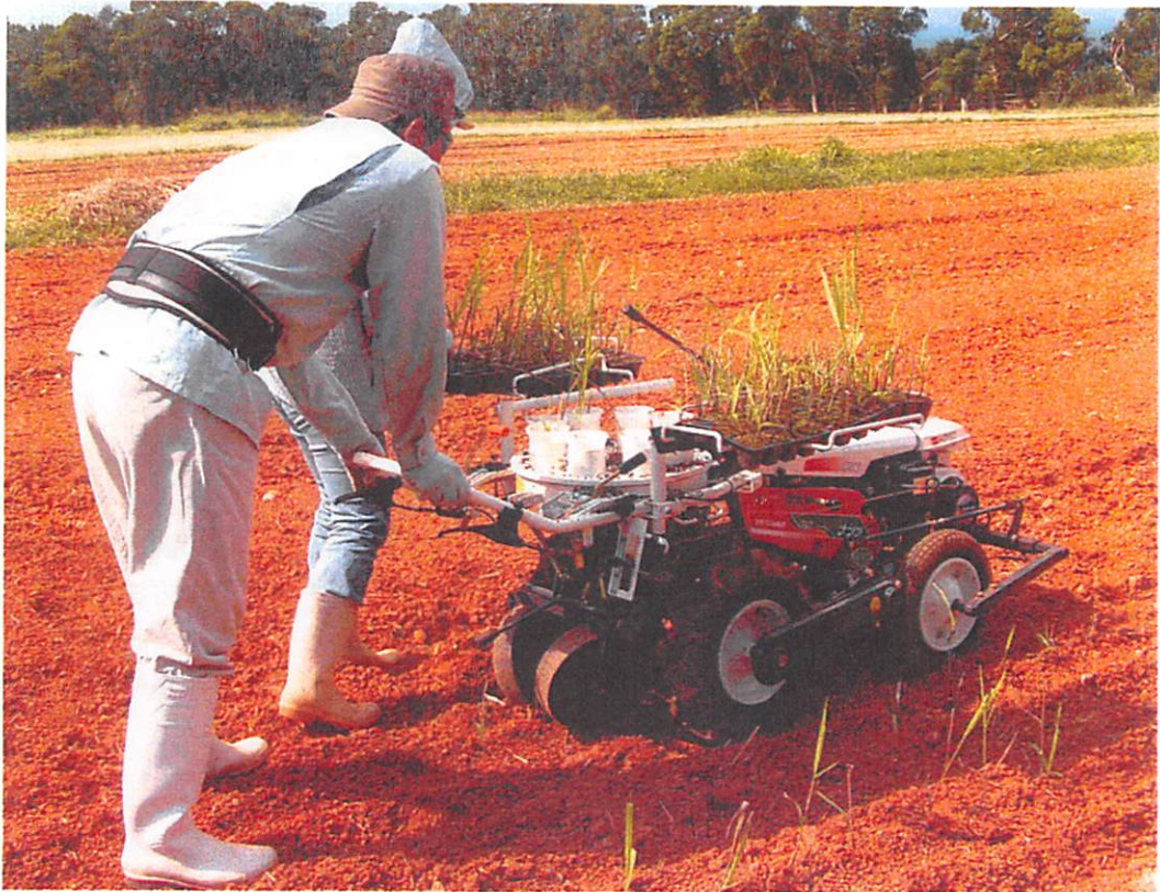
写真 MG5セルトレイ苗の野菜移植機による植付けの様子
