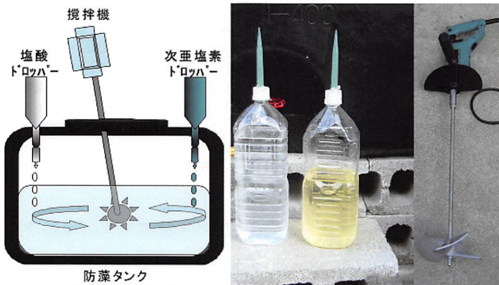
図2 殺菌水簡易製造機イメージ図（左）と使用器具（中：薬品添加ドロッパー，右：攪拌機）
