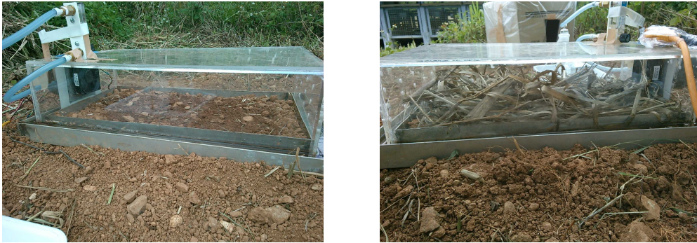
写真1 サトウキビ残渣なし(左)およびあり(右)の状態のアンモニア揮散測定用チャンバーの様子
