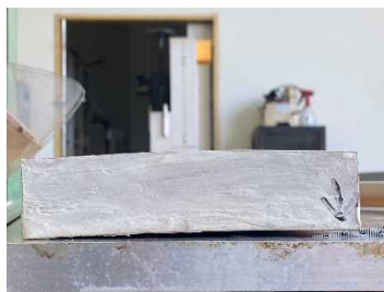
図-2 木材のくるいの測定 (左：ねじれ、右：幅そり)
