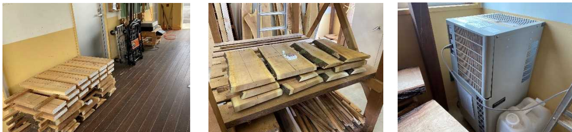
図-1 天然乾燥試験の積み状況（左：通常、中央：除湿、右：使用した除湿機）
