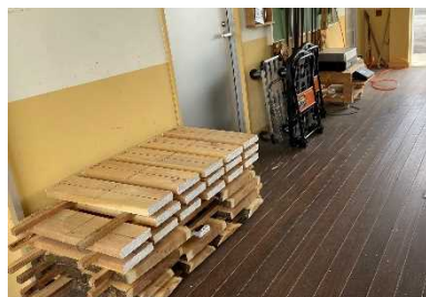
図-1 天然乾燥試験の栈積み状況
