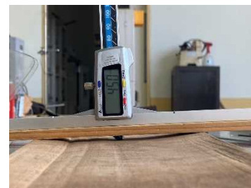
図-2 木材のくるいの測定 (左：ねじれ、右：幅そり)
