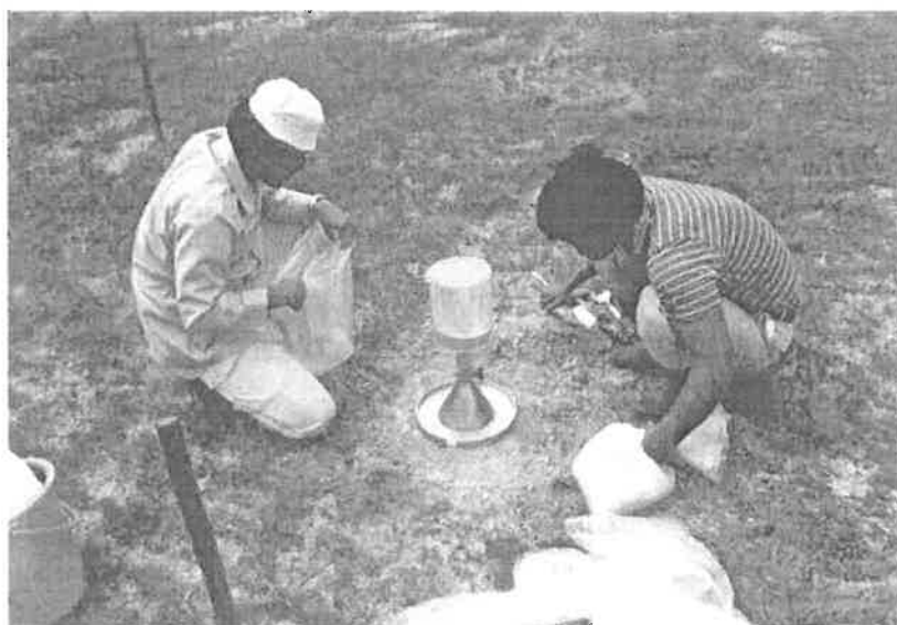
写真1 砂置換法による現場乾燥密度の測定
