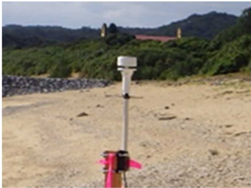
図-7 2次元超音波式風向風速計
