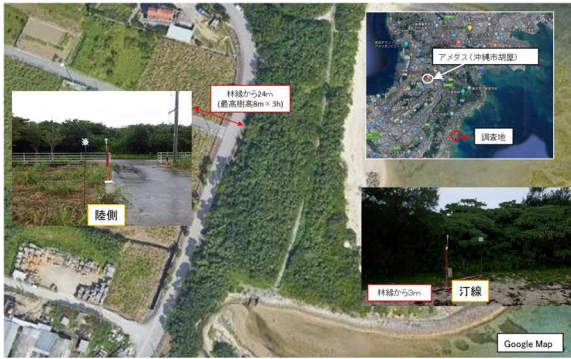
図-13 安里の調査機器設置状況
