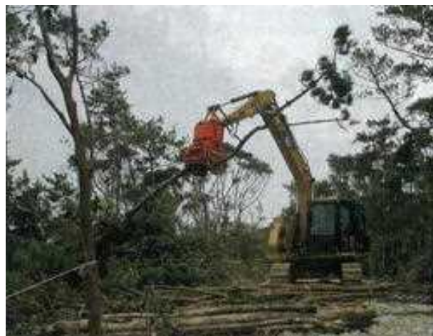
高性能林業機械（スイングヤード） を使用した択伐実証試験（国頭村）
