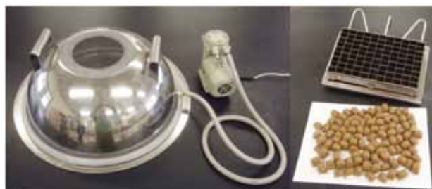
写真 1 黒糖製造に用いた密閉容器と真空ポンプ、型
