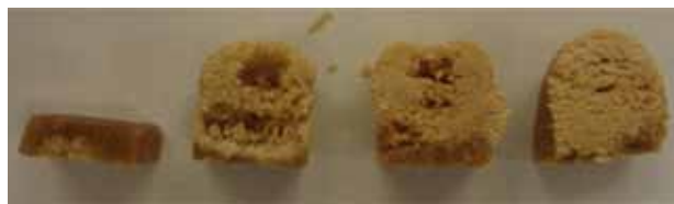
写真2 真空脱気のタイミングの違いによる黒糖の膨張程度 (左から攪拌羽根にかかるトルクが 0.01 N・m 未満, 0.01 ~ 0.02N・m, 0.06 N・m のタイミングで攪拌を止めて真空脱気した)
