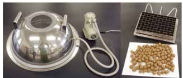
写真 1 黒糖製造に用いた密閉容器と真空ポンプ、型
