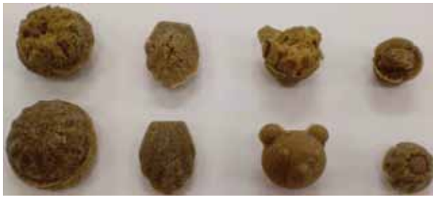
写真5 素材の異なる型で成型したエアイン黒糖 (左からスチール・フッ素樹脂加工, スチール・シリコン加工, シリコーンゴム, ABS樹脂. 上段は黒糖の上の部分, 下段は黒糖が型に接触していた面)
