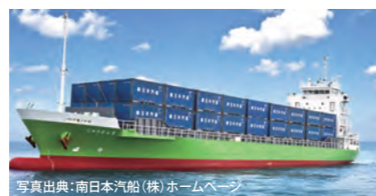
○主な寄港船舶 コンテナ船 船名：リゅうなんIII 総トン数：637G/T 全長：84.22m
