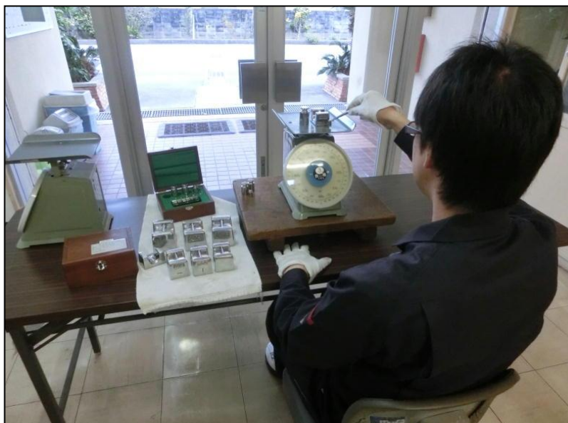
はかり定期検査の様子
