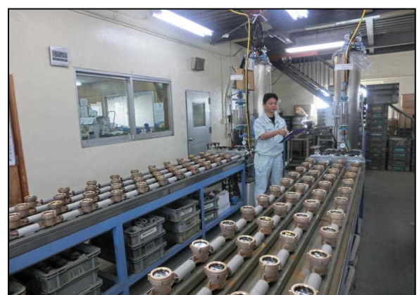
水道メーター検定の様子
