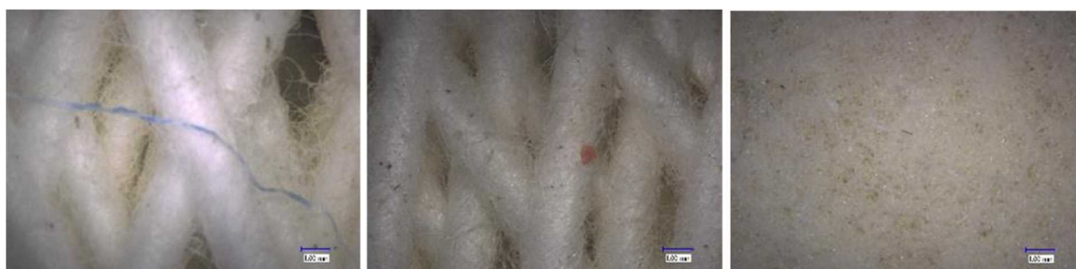
図2 回収したフィルター拡大写真（左:粗ろ過、中:中ろ過、右:最終ろ過） 不純物をきちんろ過しており、異物のない海水に処理可能である。
