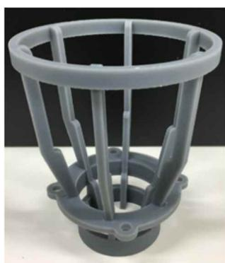
図3 光造形機にて試作した新規瓶ホルダー
