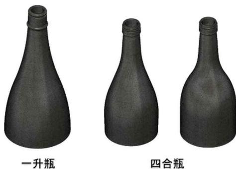
図1 X線CTスキャナにより取得した瓶のスカンデータ
