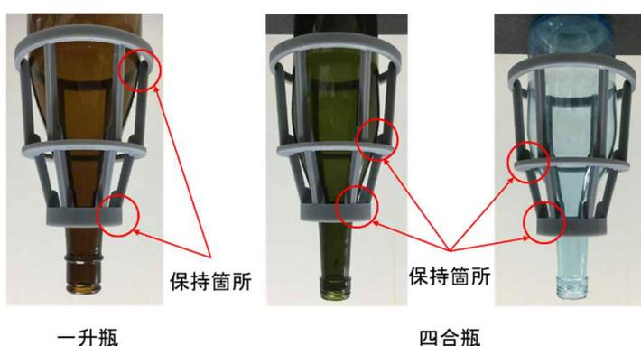
図4 光造形機にて試作した新規瓶ホルダー（保持状況）
