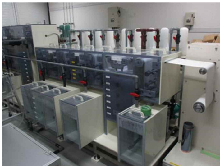
図 1. RtoR 方式による金めっき装置
