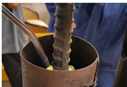
図3 炭酸ガス雰囲気での接合
