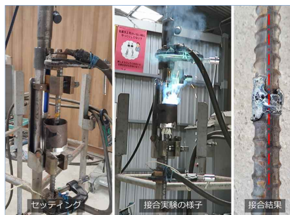
図2 絶縁性および芯出し精度の検証
