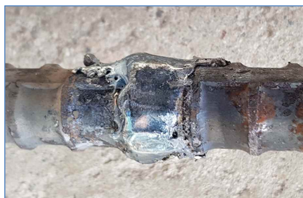
図6 溶融金属の保持による接合結果
