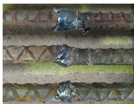
図4 炭酸ガス雰囲気中での接合結果
