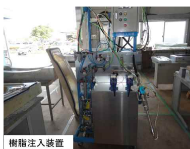
図2. 樹脂注入装置
