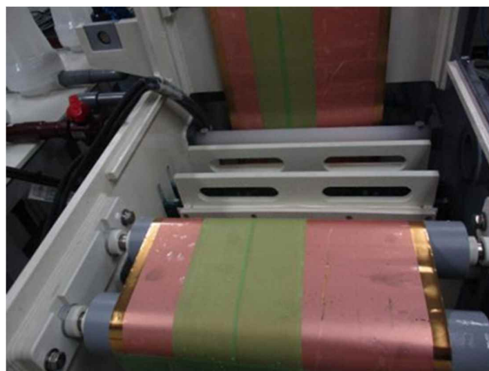
図 2. 電解 Au 槽 (基板両端に金めっき処理)
