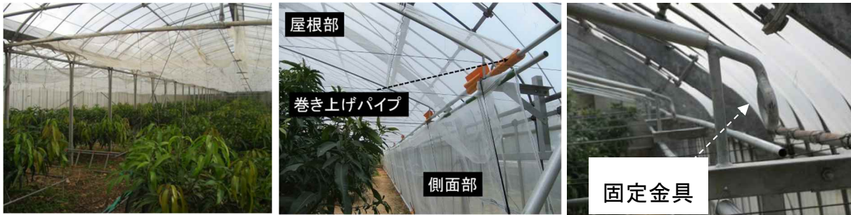
図1 従来の風よけネット 図2 二重カーテン装置の設置状況（左）と屋根部の固定金（右）
