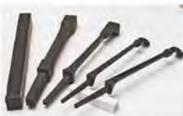
三線の棹の製作工程 (写真提供：沖縄県三線製作事業協同組合)
