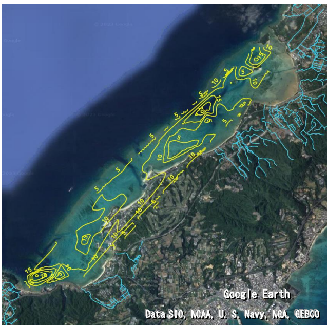
図 4. 蓄積リンの空間補完図 (TIN 内挿).
