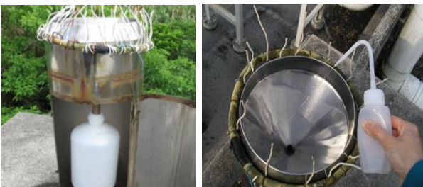
写真③：降下物捕集装置（針金は鳥除け）
