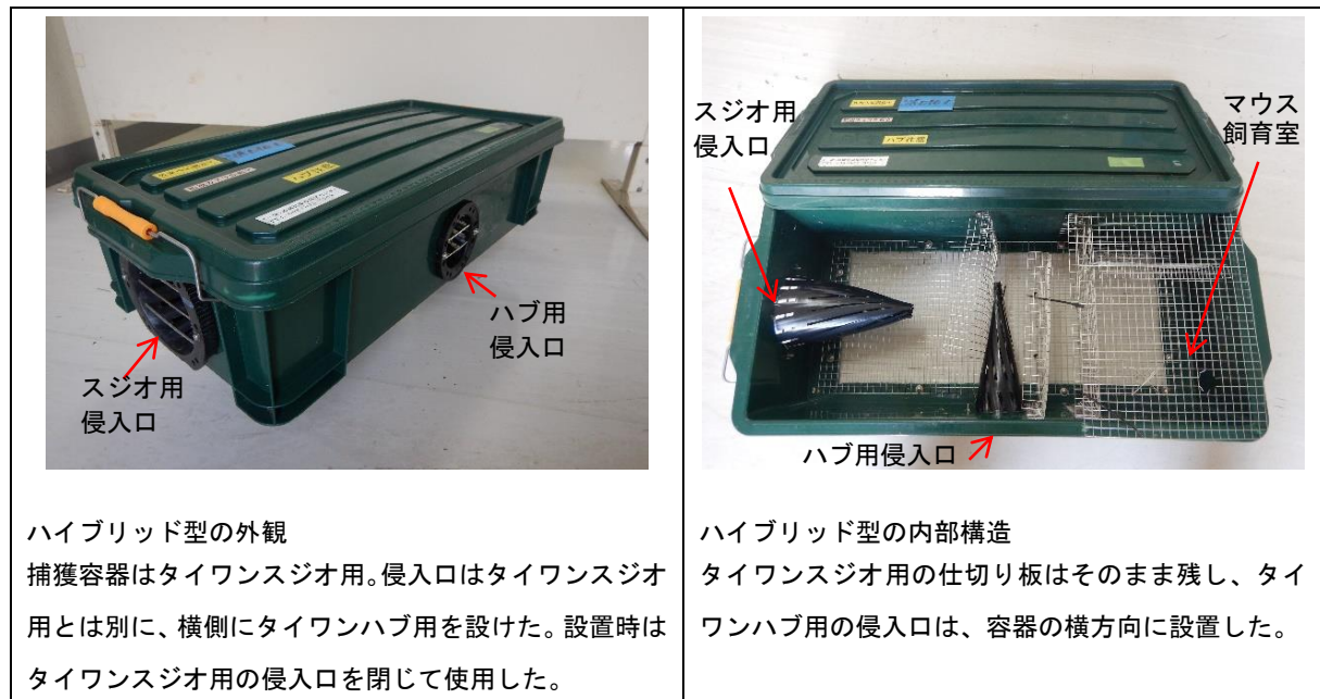
図 4-2-2.4 タイワンスジオ用のトラップを改良したハイブリッド型
