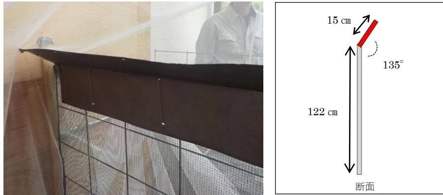
図 3-6-2.2 使用したヘビ返しの写真（左）とその模式図（右）
