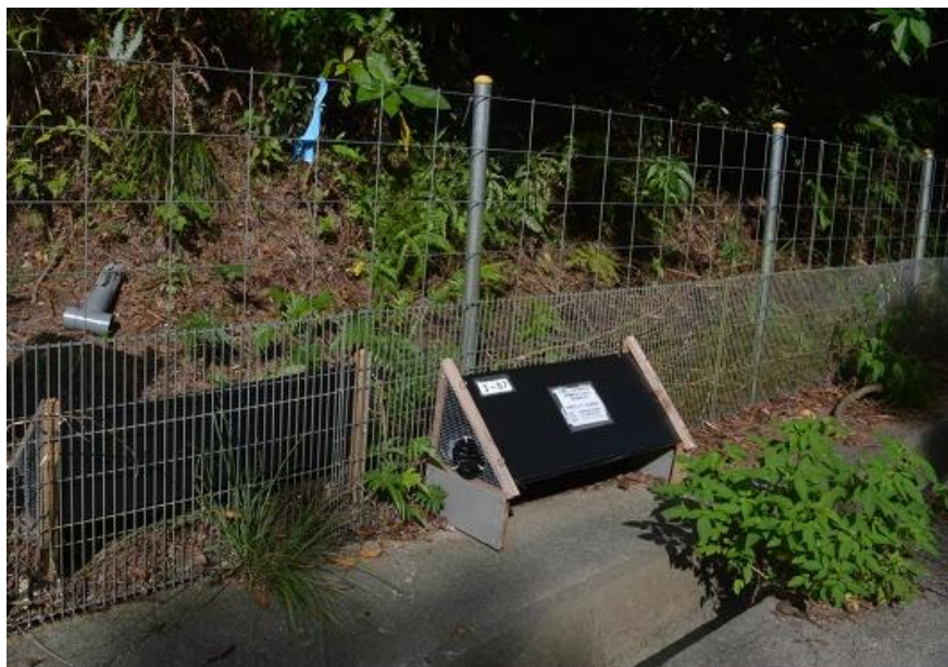
図 3-7-1.5 第三柵の近景及び柵の抜け部分周辺に設置された三角トラップ
