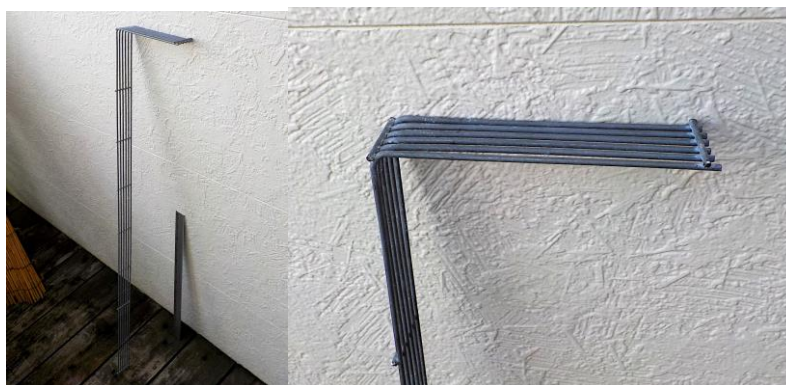
図 3-7-2.3 柵上部の改修案「D①」の試作品。右は頂部の拡大写真。スリットのたわみ止めの設置間隔は 15~20 cm。定規の長さは 60 cm。
