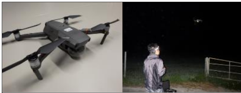
図 3.4 サーマルドローン（左：DJI Mavic 2 Enterprise Advanced）および調査状況（右）
