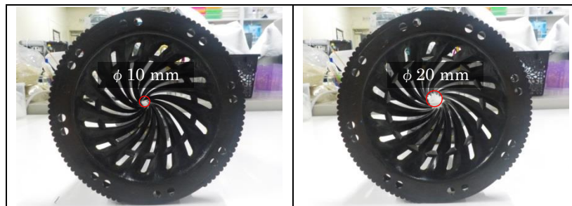
図 3-2-2.4 ハブトラップに使用されているロート（左）と先端の隙間を大きくしたロート（右）
