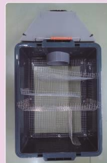
試験中のトラップ。体の長いタイフンスジオに合わせて入り組んだ構造になっている。
