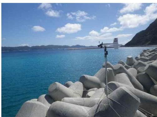
図 3.3.1-8 調査海域直近の防波堤に取り付けたカード式風向風速測定装置
