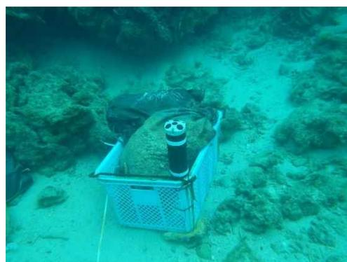
図 3.3.1-9 海底に設置した超音波ドップラー流速プロファイラー
