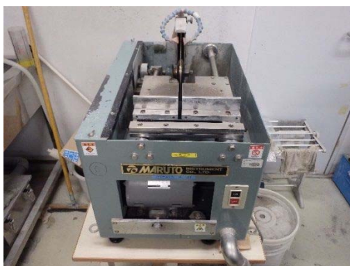
写真 3.2.1 コア整形に用いるディスクカッター
