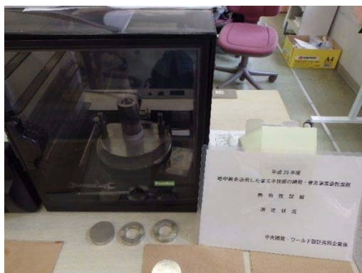
写真 3.2.6 ホットディスクによる測定
