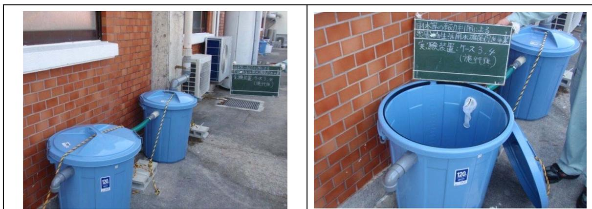
ケース3は初期雨水をカットしない、スクリーン及び沈殿槽のモデルを想定している。雨水がスクリーン（ステンレス製ざる）を通過して、容量120Lの容器に集水されるモデルである。このモデルは、雨水が容器内で滞留するため、浮遊物を沈降させる沈殿槽の役割がある。
