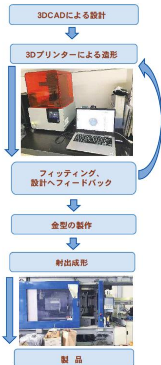
図1 3Dプリンターを使用した開発工程
