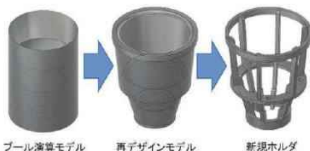
図1 瓶ホルダーの設計過程
