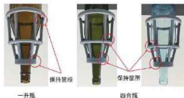
図2 試作した新規瓶ホルダーとホールド状況
