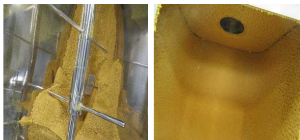
ホッパー中の原料 原料投入口の状態
