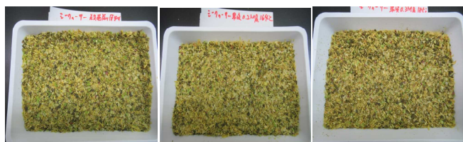
殺菌前原料末 0.2MPa(164°C) 0.3MPa(185°C) 図 4 シークワサー粉末における殺菌前後の品質（色）の変化（抜粋）
