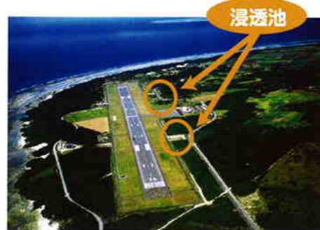
新多良間空港における浸透池設置の事例
