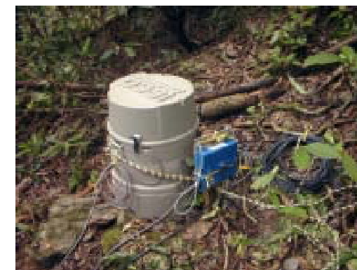
【自動採水器の設置状況例】
