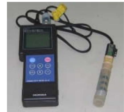
【導電率計(塩分計測)(株堀場製作所製)】
