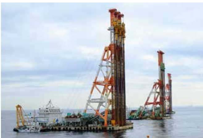
写真3 海底の軟弱地盤を改良する地盤改良船(SCP工法・写真提供:ピクスタ)
