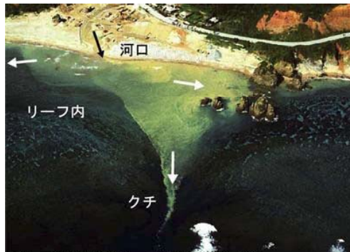
海へ流入し拡散して堆積する赤土等 (一部リーフの切れ間(クチ)から流出している)
