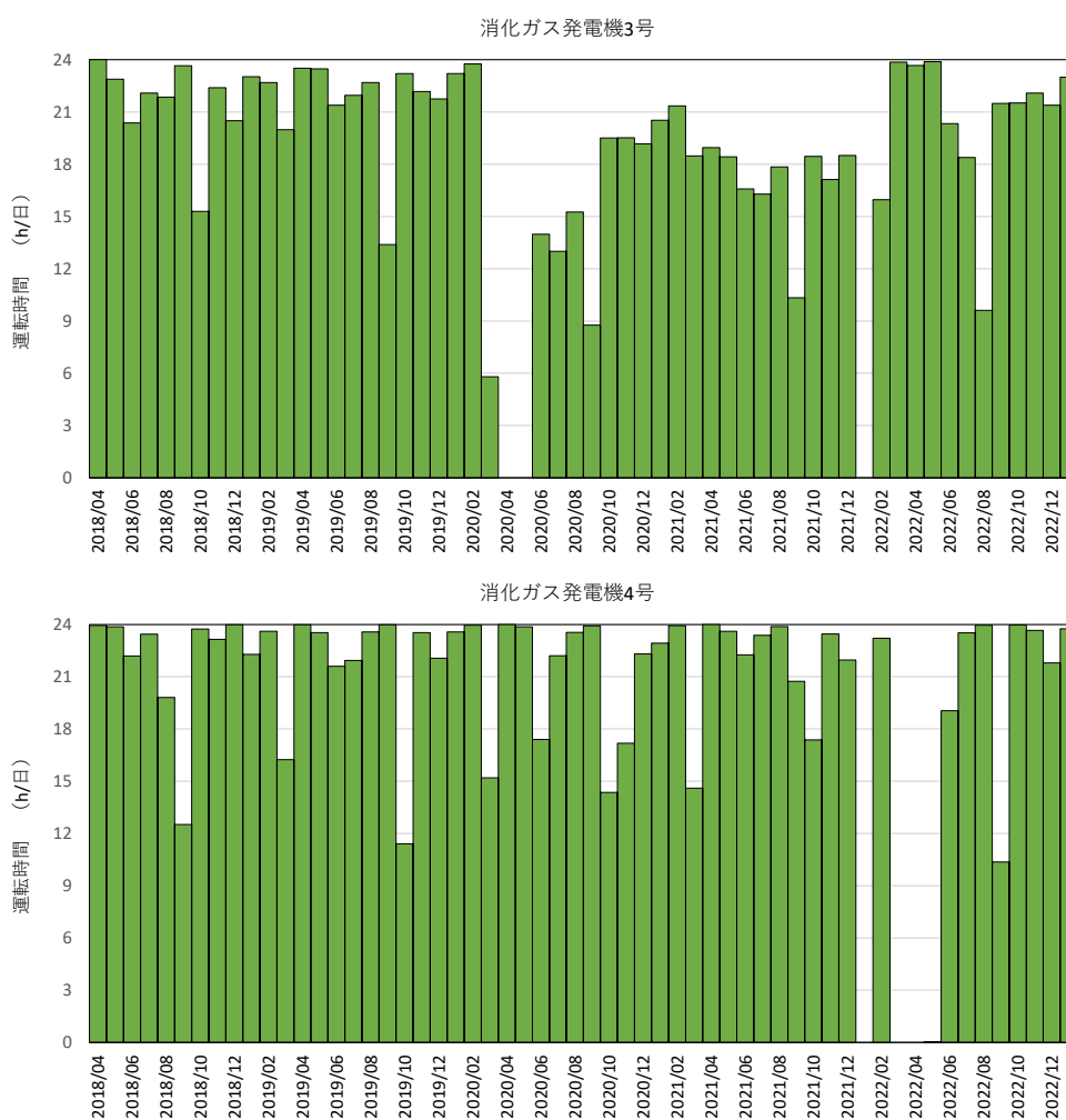
図 1-23 消化ガス発電設備稼働時間 (2/2)
