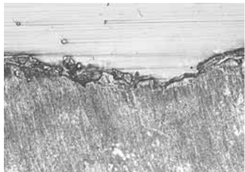
図17 圧痕の断面写真：底部（白色試料）
