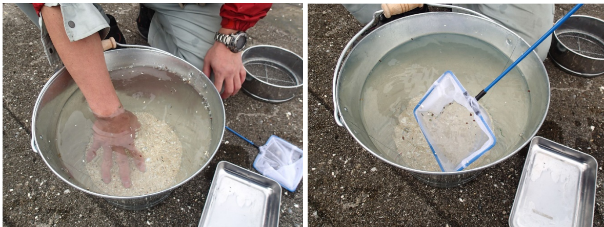
図 5.5-11 攪拌作業（左側）静置後浮上したプラスチック等（右側）
