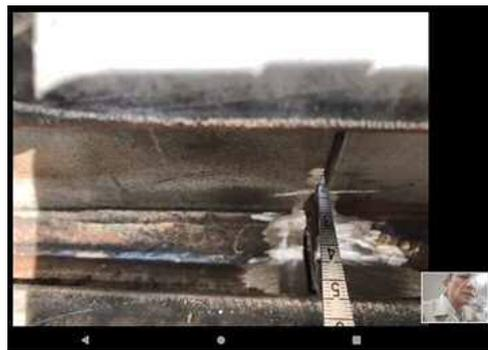
【継手部隙間測定】
